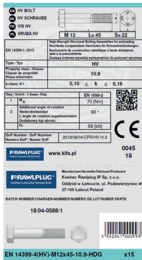
Abb 11. Beispielbild eines Etiketts für eine Schraube nach Klasse K1.
